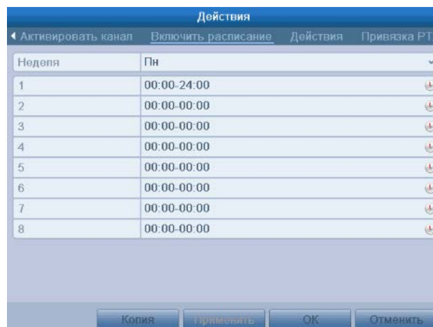
Рис. 9.8 Установка расписания активности тревожного входа
